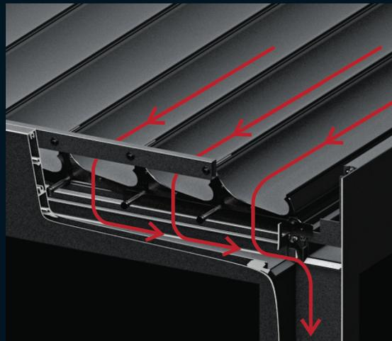
Les lames en aluminium ont été conçues pour guider l'eau par des gouttières intégrées.
